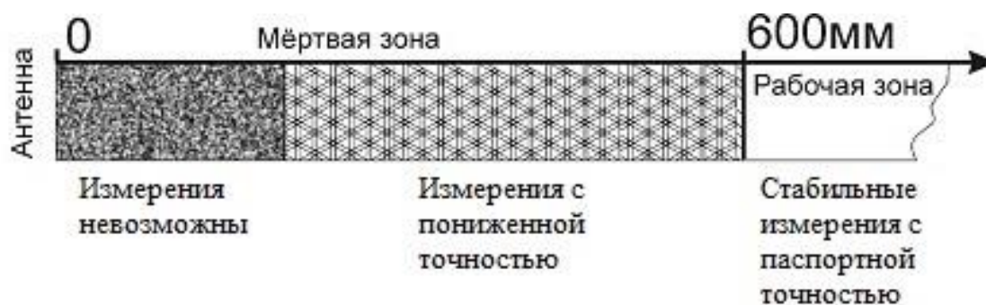
Рис. 4.5 Мертвая зона уровнемера.
