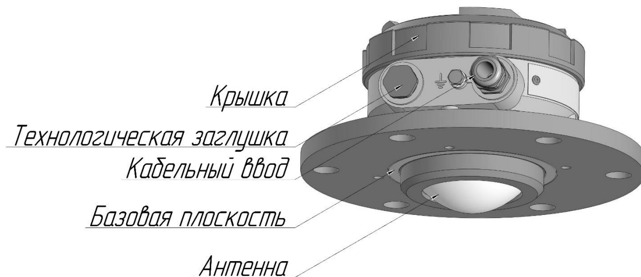
Рис. 3.1. Внешний вид и расположение основных элементов уровнемера УЛМ-31-НФ, УЛМ-31А1-НФ.
