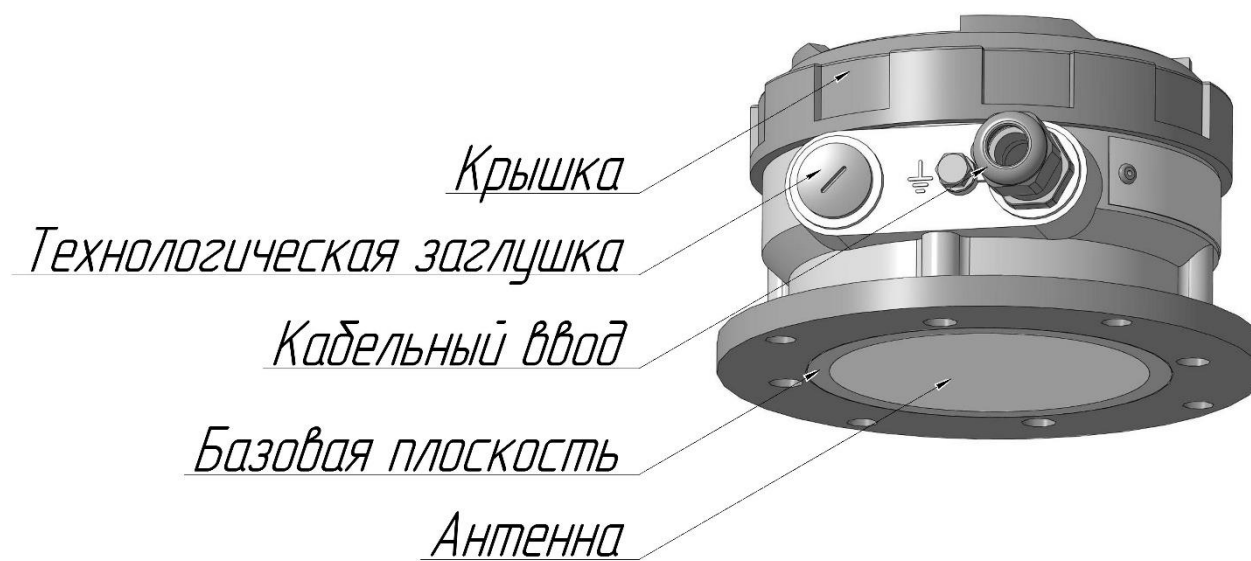
Рис. 3.2. Внешний вид и расположение основных элементов уровнемера УЛМ-31А1.
